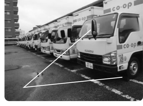
下の写真の三角部分については、運転席に乗車した際、直接見ることができません。
