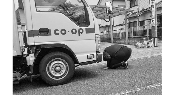
乗車する前、左回りで輪止めを取り安全確認をする地域責任者の橋晋太郎
