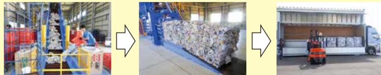
ペーラー(圧縮機)のコンベアへ回収したカタログを投入します。(※異物が入っていた場合コンベアを止め除去します)
